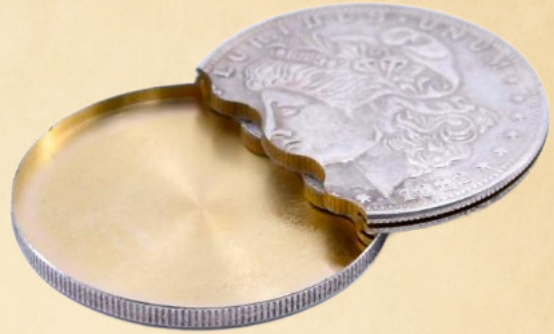
Abb.: Hier ist eine magnetische Flipper Coin vollständig aufgeklappt dargestellt. Man erkennt sehr gut die äußere Shell, den beweglichen Münzeinsatz, den zentralen Magneten und vor allem die als „Rubber Band Hinge“ bezeichnete Verbindung.
